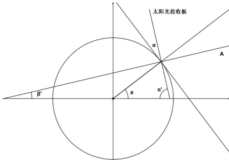
如上图所示, 正午时, 南京的热水器太阳光接收板平面的法向量为  $\vec{n}_0 = (\cos\beta', 0, \sin\beta')^T$ , 而  $\beta' = \frac{\pi}{2} - \alpha'$ ,  $\alpha + \frac{\pi}{2} = a + \alpha'$ , 故  $\beta' = a - \alpha$ , 因此有
